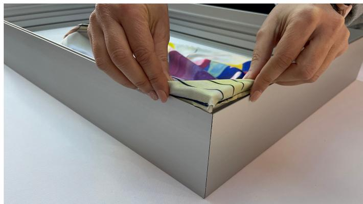
**2.** Prenez un coin de l'impression sur tissu de remplacement et insérez le joint de silicone dans la fente du cadre ou du boîtier lumineux. Répétez la même opération pour chaque coin de l'impression sur tissu de remplacement.
